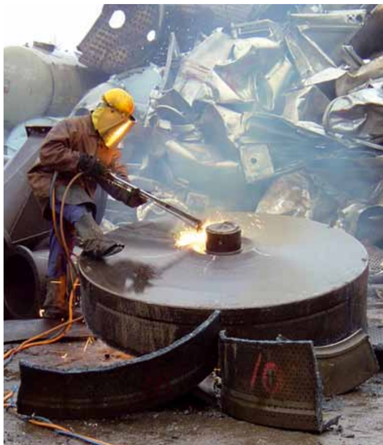
Cięcie plazmą złomu wielkogabarytowego.
