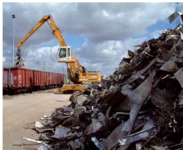
Załadunek na wagony kolejowe złomu przygotowanego pod specjalny model wytopu.
